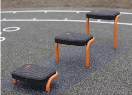
Der Stützrahmen besteht aus  $\varnothing 48,3 \times 4$  mm Carbonstahl mit einer feuerverzinkten Oberfläche gemäß ISO1461 und einer Pulverbeschichtung der Korrosionsklasse C3 gemäß ISO12944-2. Der Bleigehalt der Oberflächen liegt unter 90ppm.
